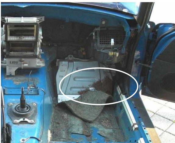
fig 5 - Corrosão na tampa do ECU sob o tapete
