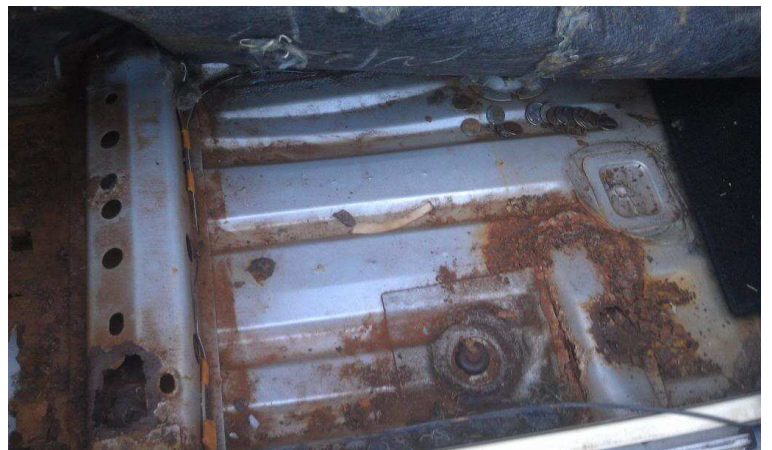
fig 6 - Corrosão no piso embaixo do tapete
