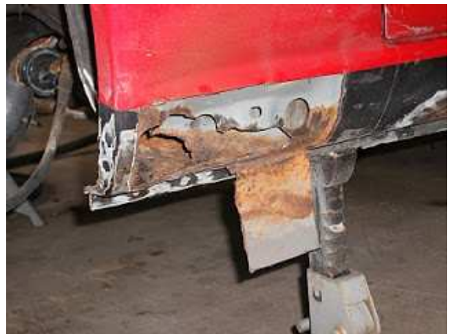
fig. 4 - Para-lamas dianteiros com ferrugem (exemplo)
