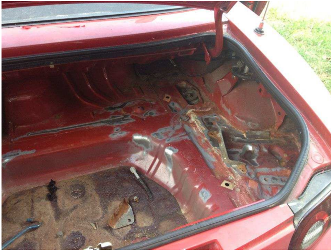
fig. 7 - Danos causados por um vazamento na bateria.
